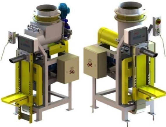
Ensacadoras destinado al embolsado de productos con alta humedad (polvo químico, polvo alimenticio, masa corrida, cal virgen / hidratada, entre otros) Los productos con baja densidad y bajo flujo, en bolsas valvuladas, con válvula superior o lateral. El producto del silo se transporta mediante una rosca helicoidal y se deposita en la cámara inferior (caja de tornillo), desde donde sale a la boquilla de llenado para caer en el recipiente de embolsado.
