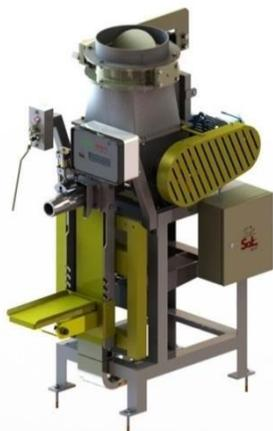
Máquina ensacadora para embolsar productos en polvo de bajo flujo en bolsas con válvula con válvula superior o lateral. El sistema de ensacado consta de dos roscas helicoidales que direccionan el producto dentro de la tolva desde los bordes hacia el centro, donde un rotor de cinco palas dirige el producto hacia la boquilla de llenado.
