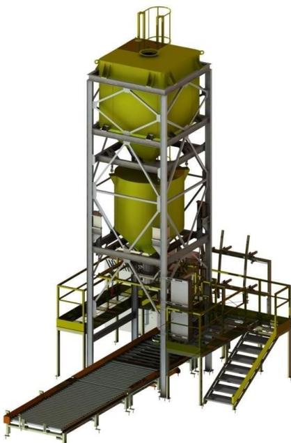
Máquinas destinadas para el ensacado de productos sólidos en Bags, con pesaje directo o previo, mediante células de carga. Las máquinas de ensacado permiten el uso de carros de manejo de rieles o cintas transportadoras para transportar las Bags llenas para el local de depósito. Para productos en polvo, existe la estera con mesa vibratoria opcional, que está diseñado para densificar aún más el producto en la Bag por medio de vibración.
